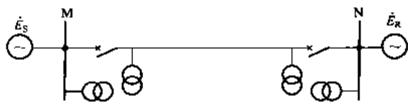
图 3-91 检查线路无压和检查同期重合闸
